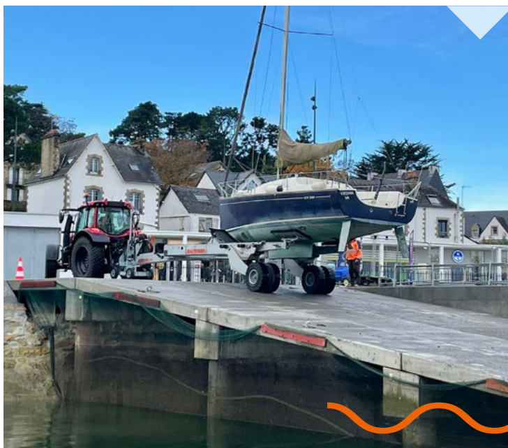
Sortie de l'eau d'un bateau depuis la nouvelle cale sur la remorque tractée par le tracteur.
